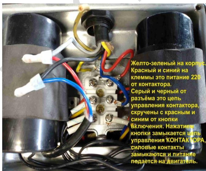
Подключение торцевателя МСПТ-400 (220В.)
